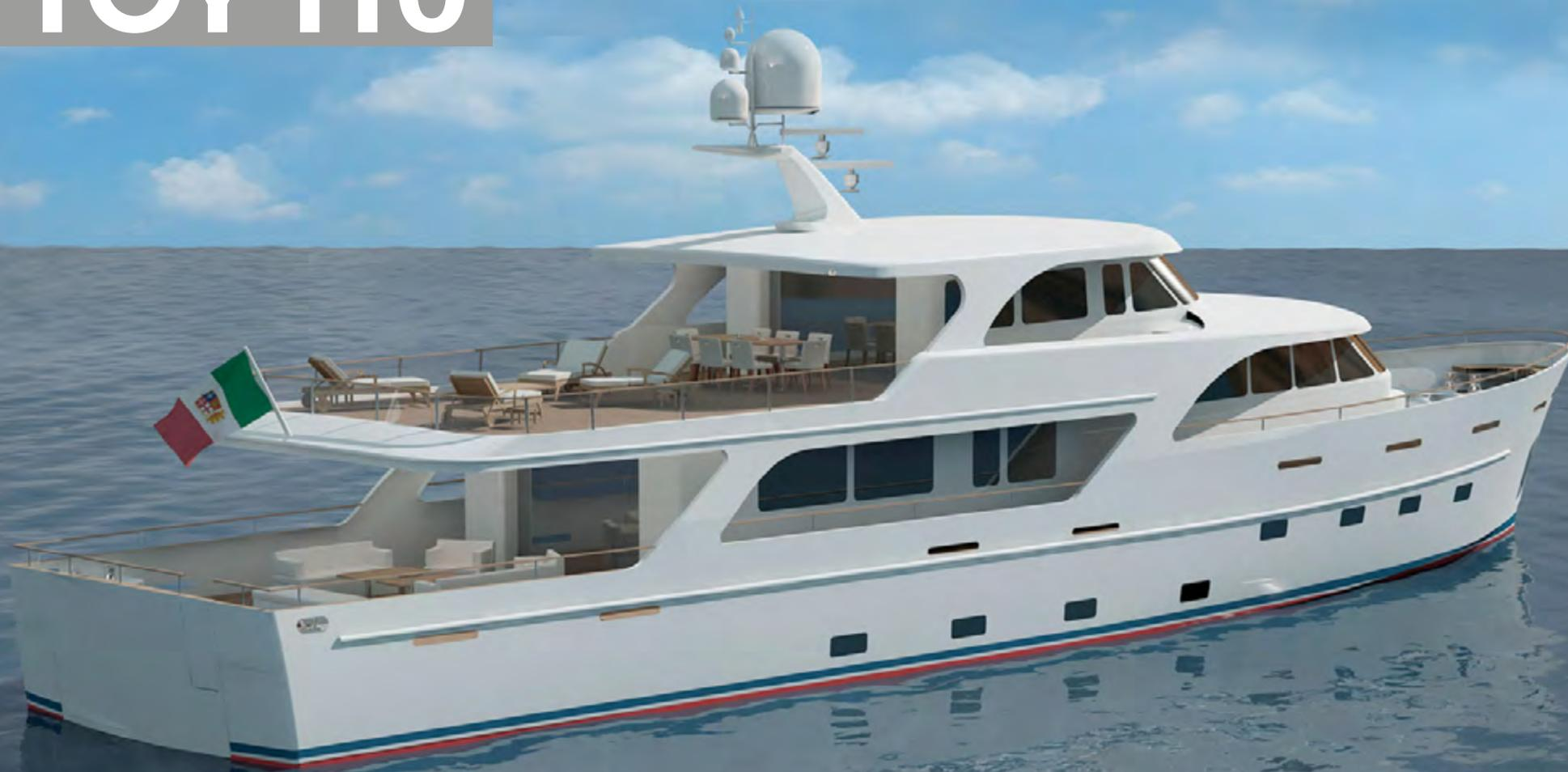
Il Toy 110 è l'interpretazione del modo di andare per mare di Toy Marine applicata ad una navetta di oltre 33 m fuori tutto. La costruzione è di acciaio per lo scafo e di alluminio per le sovrastrutture, le linee sono di ispirazione classica, riviste però attraverso l'interpretazione di Toy Marine.
